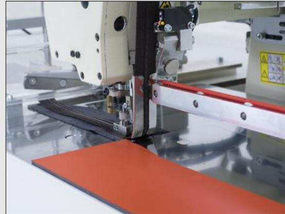
Anlageschablone und RV-Führung sichern gleichbleibende Nahtqualität und garantieren ein optimales Nähergebnis
