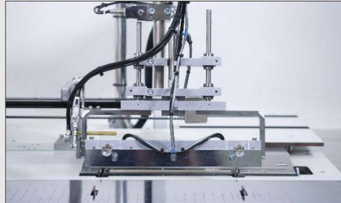
Falter zur Aufnahme und Positionierung von Taschenstücken und Schlitzleisten
