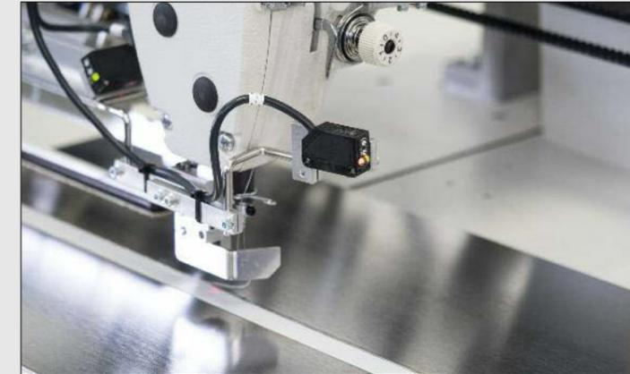
Fotozellen für Nahtanfangs- und Nahtenderkennung
