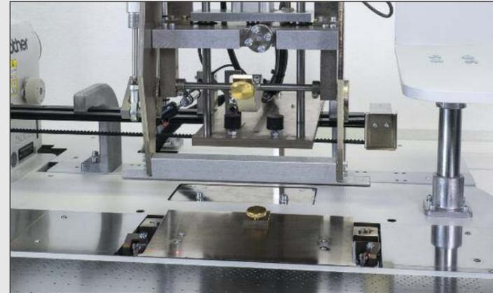
Mit Hilfe der modellspezifischen Markierungen kann das Nähgut exakt für den nachfolgenden Nähprozess positioniert werden.
