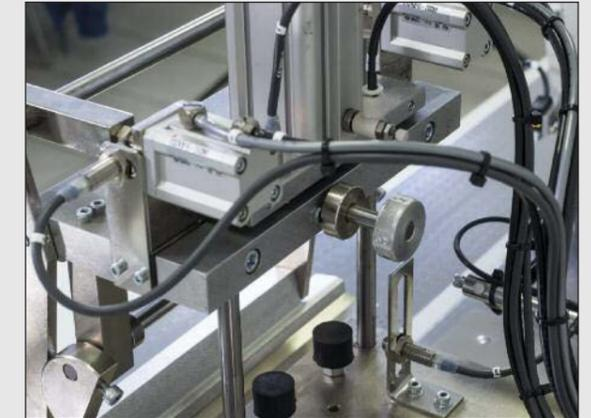
Die Nahtbreiten werden mechanisch eingestellt
