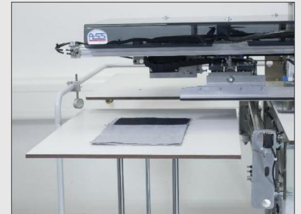
Der Stapler legt die Nähteile für den nachfolgenden Arbeitsgang ab
