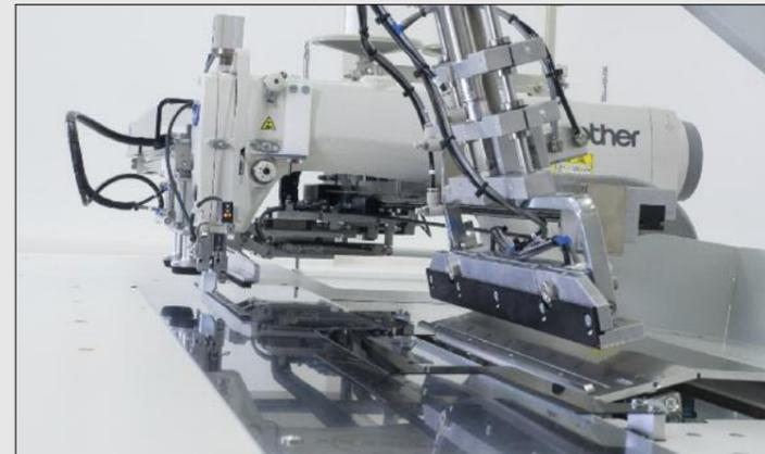
Nach Vorlegen des Taschenbeutels und dem Einlegen des Besetzen arbeitet die Maschine automatisch die folgenden Arbeitsschritte wie Einschub, Nähvorgang und Abstapelvorgang ab.
