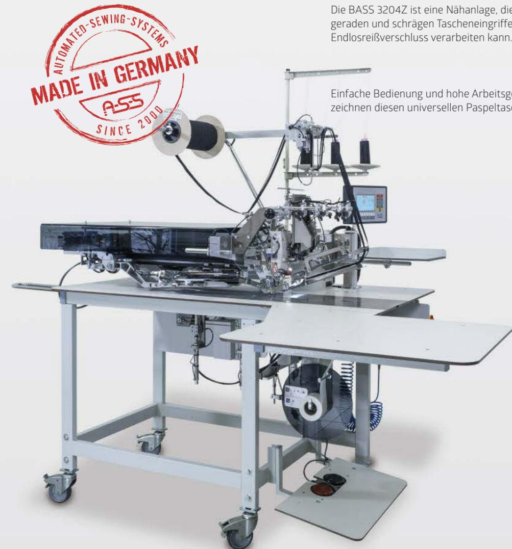
Die BASS 3204Z ist eine Nähanlage, die alle gängigen geraden und schrägen Tascheneingriffe mit integriertem Endlosreißverschluss verarbeiten kann.
