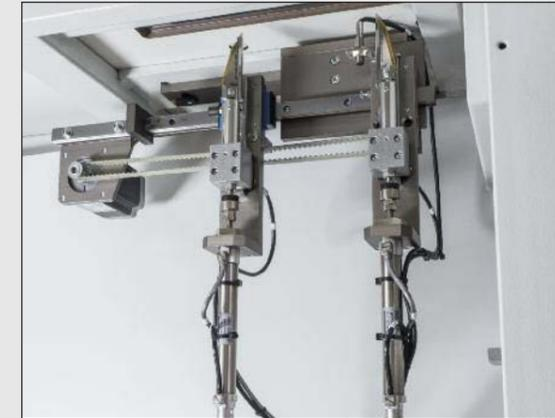
Messerblock mit Schrittmotorantrieb
