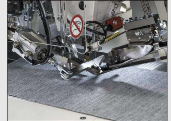
Pneumatische Schere zum Abschneiden des Endlosreißverschlusses
