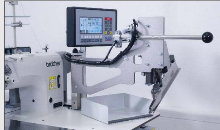
Die ausschwenkbare Flapstation ermöglicht einen leichten Zugang bei Rüst- und Servicearbeiten
