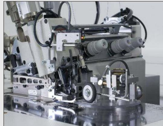
Eine optimale Einheit bilden Konturenführung, Fotozelle und Nähkopf
