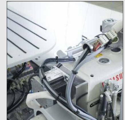
Schrittmotorgesteuerter Differential- und Obertransport
